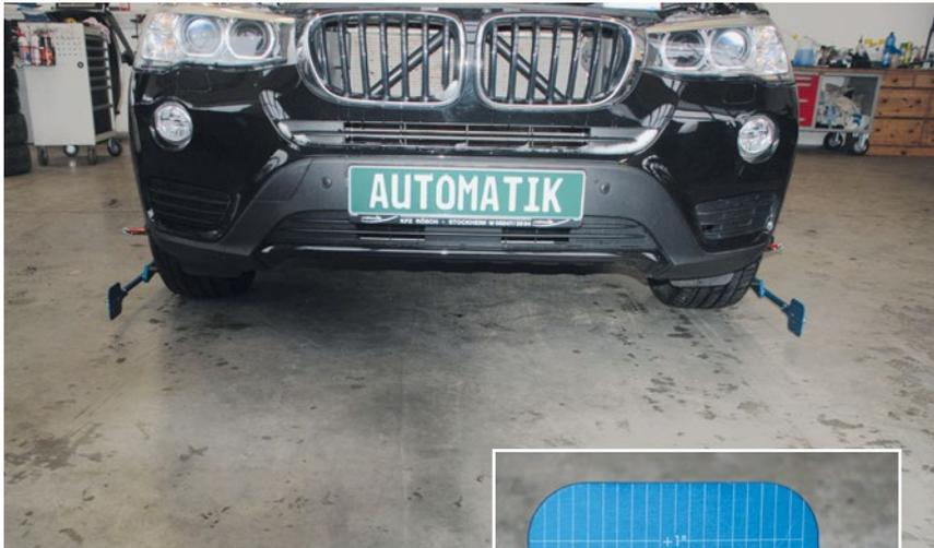
Der Laser befindet sich in der Mitte der Skala der jeweiligen Vermessungseinheit und wirft seinen Strahl auf die gegenüberliegende Seite (oben). Hier wiederum muss der Fachmann den Spur- und Sturzwert ablesen. Für die rechte Seite wird also links abgelesen und umgekehrt. Im kleinen Bild (rechts) liegt der Vorspurwert (+) bei etwa 3" und der Sturz bei etwa  $-0,75^\circ$ .
