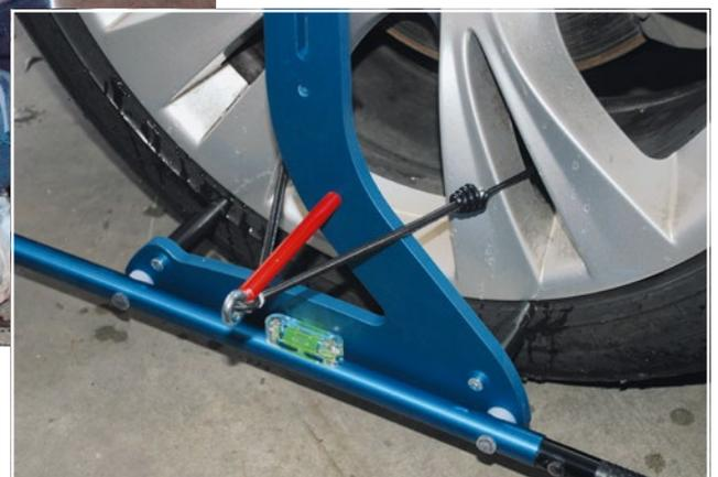
Der Welso-Spurlaser lässt sich mit den Gummibändern (kleines Bild) sehr schnell am Rad fixieren, wie Manuel Rösch von Rösch Kfz- und Landtechnik demonstriert. Der Fachmann nutzt den Spurlaser seit mehreren Jahren. Bilder: Schmidt
